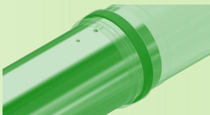
3) RUOTATARE I TUBI IN SENSO OPPOSTO (COME DA FIGURA A SINISTRA) MA NON OLTRE I 176°. INOLTRE È POSSIBILE ACCOPPIARE IL TUBO FLESSIBILE CON TUBI, CURVE E/O TEE DELLA MEDESIMA LINEA.
