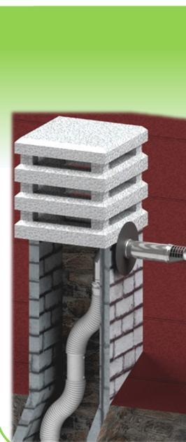
**Kit per scarico da cavedio Ø80:** E' un Kit di componenti per lo scarico dei fumi da un cavedio preesistente, per caldaie a condensazione di classe C fino a 35 KW. Il Kit prevede un terminale ANTIGOCIA in PP, un manicotto in Acciaio Inox 316L M/F, una curva a largo raggio con VITE PER IL FISSAGGIO su tubo all'interno del cavedio ed un rosone in metallo.
