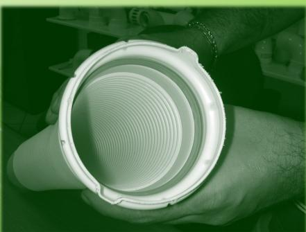
**2) MONTARE LA GUARNIZIONE IN EPDM
